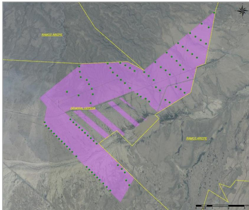
Los elementos del Proyecto incluyen la instalación de hasta 95 aerogeneradores, dos subestaciones y una línea de transmisión. La energía producida por cada aerogenerador será transportada a la subestación de elevación a través de líneas de transmisión subterráneas de 34.5 kV. El Proyecto se conectará a una subestación adicional a través de una línea de transmisión aérea a 230 kV que extenderá cinco kilómetros. Una red de caminos de 63 km dará acceso al sitio y a los aerogeneradores.
